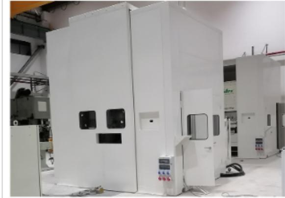
可减少噪音的录音配套隔音箱，包括箱体，箱体的前侧设置有可开合的前盖，前盖的侧壁上开有通孔，箱体的内侧壁上贴附有用于降低噪音的隔音材质，本实用新型通过箱体内设有的隔音材质，实现箱体内外有效隔音，继而便可有效地避免在录音时外界所带来的干扰，并且也可以减少声音外泄，且方便移动，占地面积小，使得其对场地的适应性更加灵活。代替隔音玻璃观察窗，提高箱体整体性和密闭性，使箱内声音的瞬态变化在隔音箱外部间接式动态实时响应，便于用户测试观察。隔音箱将两层铝板置于两层丁基橡胶之间。浙江高速冲床隔音箱厂商
